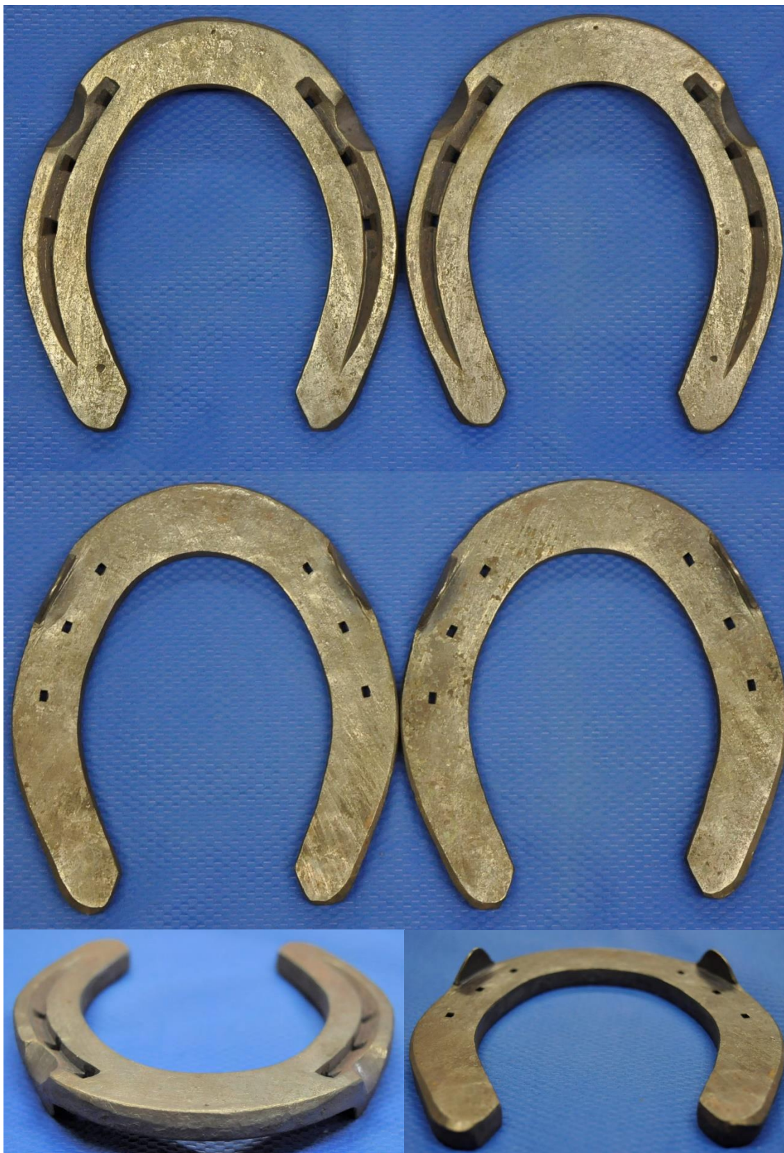
課題蹄鉄見本(横径：120mm、縦径：134mm、鉄頭部の幅 23mm)
